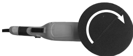
Afb. 3: De polijstschijs vastschroeven
