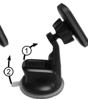
Figure 9 : Desserrer le support du smartphone
