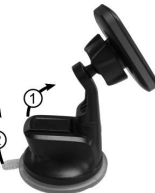
Fig. 9: Staccare il supporto dello smartphone
