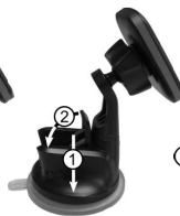
Figure 8 : Pression et fermeture du levier de verrouillage
