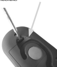
Illustration 2 : Ouverture du compartiment des piles
