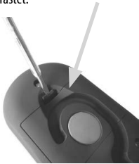
Bild 2: Öffnen des Batteriefachs
