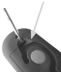
Afbeelding 2: Het batterijvak openen
