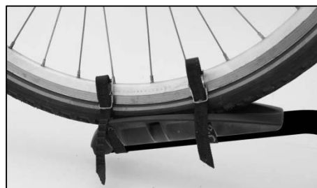
Figura 15: Cinghie di fissaggio ruota anteriore
