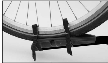
Figure 15 : Sangles de sécurité de la roue avant
