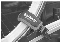
Figure 3: Monter la protection de jantes au niveau de la sangle de fixation
