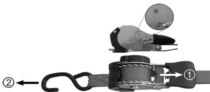
Afb. 2: De spanriem uitrollen
